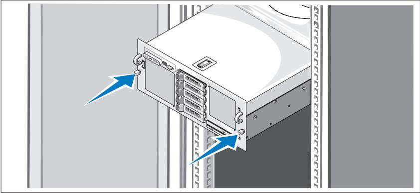
시스템의 랙 설치 안내서에 나와 있는 "안전 지침"을 읽은 후에 시스템을 랙에 설치합니다.
