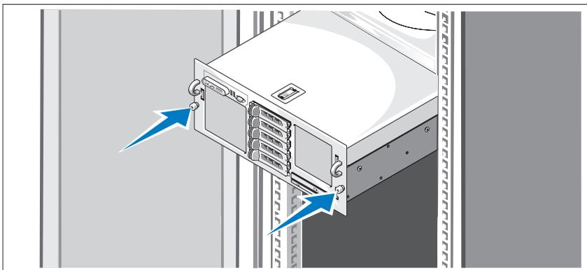
お使いのシステムのラック取り付けガイドに記載されている「安全にお使いいただくための注意」を読まれたら、ラックにシステムを取り付けます。
