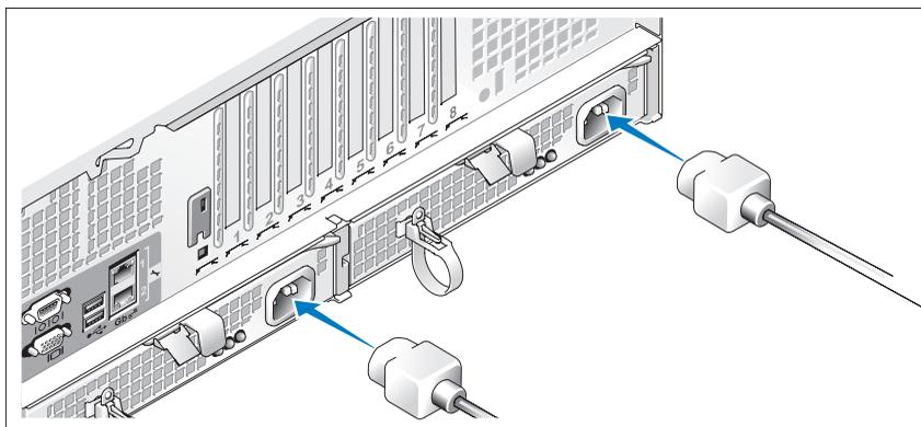
モニターの電源ケーブルをモニター（オプション）に接続します。システムに電源コードを接続します。
