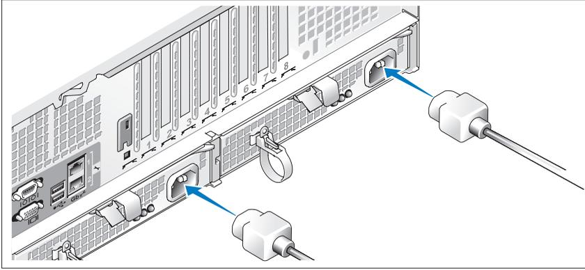
将显示器的电源电缆连接到显示器上（可选）。将系统的电源电缆连接到系统上。
